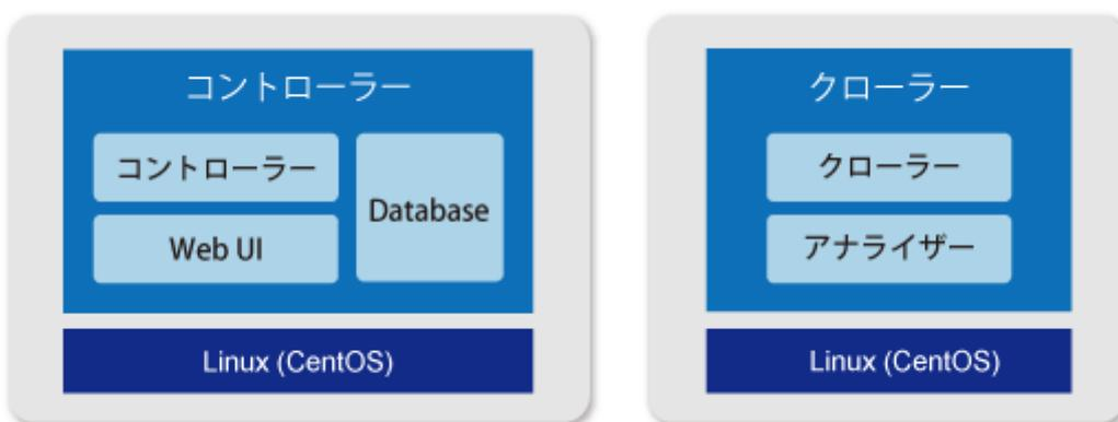
各サーバの推奨スペック: OS:CentOS 6 64bit CPU:4Core 以上 メモリ:8GB 以上 HDD:100GB 以上
